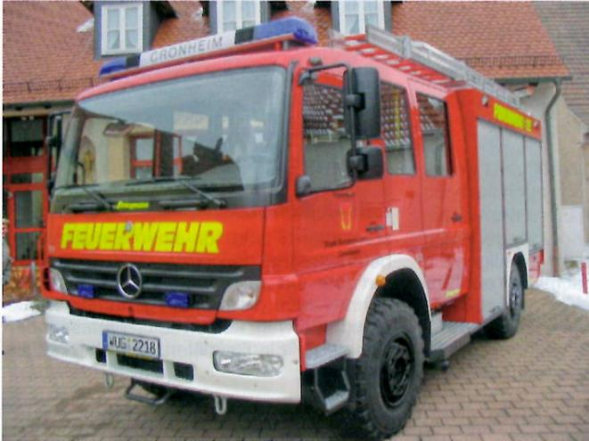
Das Fahrzeug hat neben einem hydraulischen Rettungssatz, bestehend aus Rettungsschere und Rettungsspreizer, auch einen Wasservorrat von 1.000 Litern an Bord. Das geländegängige Fahrzeug ist speziell auf die Belange des Feuerwehr-Unterstützungspunktes Cronheim abgestimmt.
