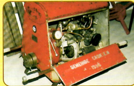
Robel TS8, Typ R8, Maschinen-Nr. 056, Baujahr 1936, Förderhöhe 80 m.
