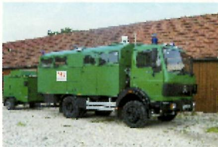
Einsatzleitfahrzeug mit Aggregat.
